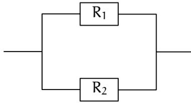
Abbildung 2: Parallel geschaltete Widerstände  $\frac{1}{R} = \frac{1}{R_1} + \frac{1}{R_2}$
