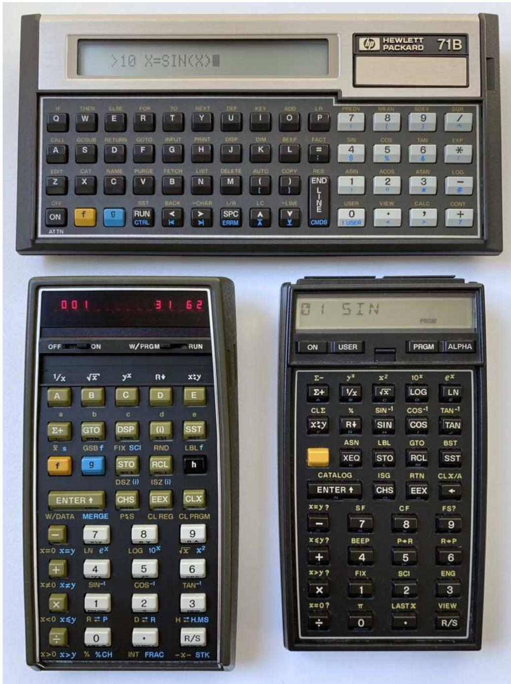
Abb. 2: Vergleich eines HP-71B oben, HP-67 links, und HP-41C rechts. Die Rechner zeigen ihre jeweiligen Repräsentationen einer Programmzeile, die eine Sinusberechnung veranlasst. Beim HP-67 und HP-41C operiert die Funktion zwangsläufig auf dem X-Register, beim HP-71B kann man in gewöhnlichem BASIC Variablen für Argument und Ergebnis der Berechnung angeben.
