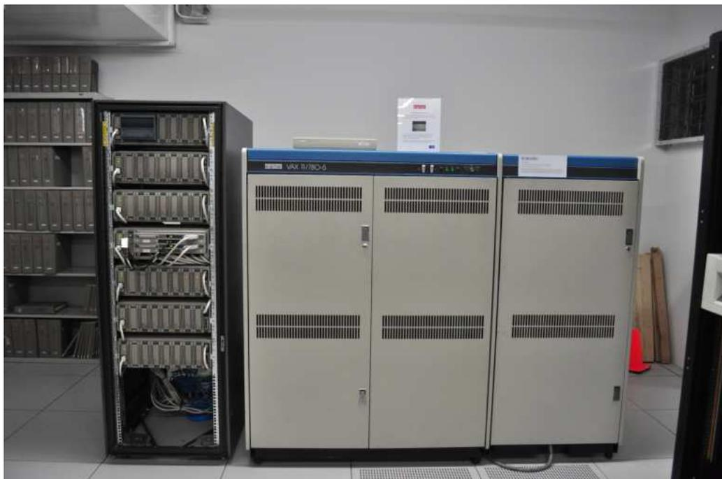
Abb. 3: Das Bild zeigt eine VAX11/780-5, die seit 1984 als Leistungssteigerung der ursprünglichen VAX11/780 von 1978 angeboten wurde, mit Erweiterung rechts und einem moderneren 19" Disk-Array links daneben. Am linken Bildrand sind Teile einer »Grey Wall« zu sehen. Auf dem mittleren Schrank steht eine 1991 eingeführte VAXstation 4000 VLC, die trotz des Größenunterschiedes etwa die vierfache Rechenleistung der 11/780-5 bereitstellt. Autor: JOEMABEL [11]
